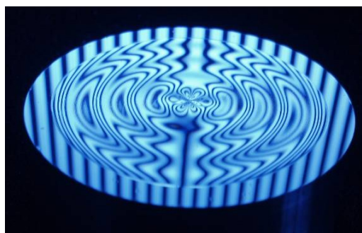
Bild: Deflektometrische Vermessung eines Freiformspiegels
