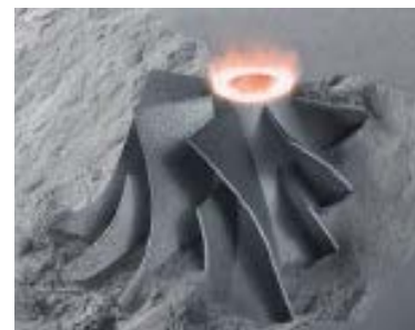
Bild 1: Additive Fertigung metallischer Bauteile mittels Laser Metal Fusion (LMF) (Quelle: TRUMPF Gruppe)
