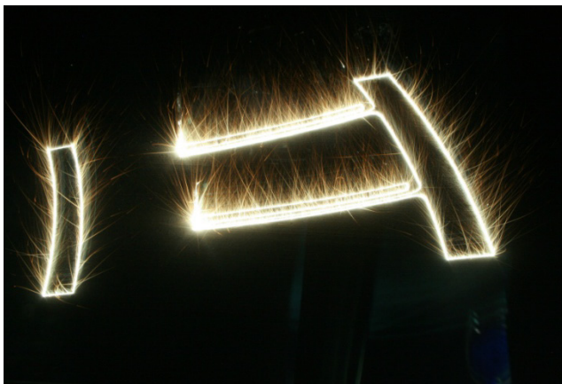
Bild 2: Langzeitaufnahme der Konturbelichtung eines Leitschaukelsegments (Quelle MTU Aero Engines)
