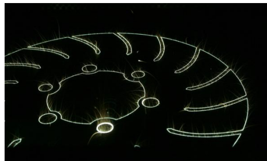
Bild 1: Langzeitaufnahme der Konturbelichtung bei der additiven Fertigung einer Schleifscheibe (Quelle: MTU Aero Engines AG)
