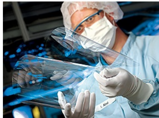
Bild 2: Dünntglas von der Rolle (Quelle: SCHOTT AG)
