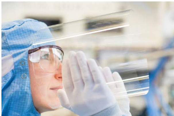
Bild 2: Dünnstglas ist ein flexibles und stabiles Substratmaterial für die Optoelektronik. (Quelle: Fraunhofer FEP)
