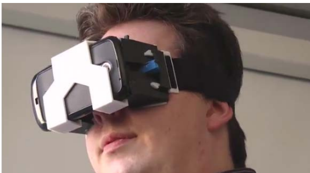
Bild 2: Open Source VR-Brille aus dem 3D-Drucker (Quelle: Durovis DIVE)
