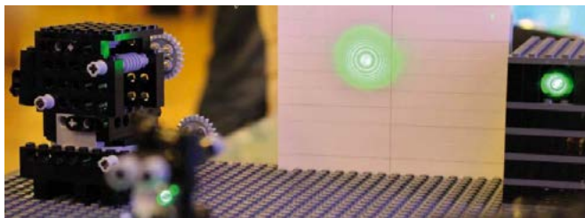
Bild 2: Interferenzmuster erzeugt mit einem Michelson-Interferometer aus LEGO®-Bausteinen. Als Laserlichtquelle (rechts) wird ein handelsüblicher Laserpointer verwendet; kostengünstige Optiken (Strahlteiler, Spiegel und Linsen) stammen aus dem Bereich astrophysikalischer Experimente. Die entwickelten Spiegelhalter (links) sind in zwei Achsen justierbar.
