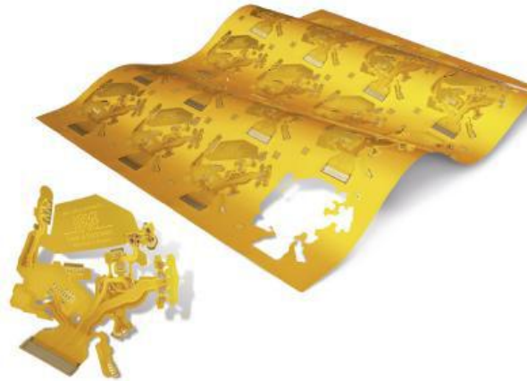
Bild 2: Lasertrennen von flexiblen Schaltungsträgern (Quelle: LPKF AG)
