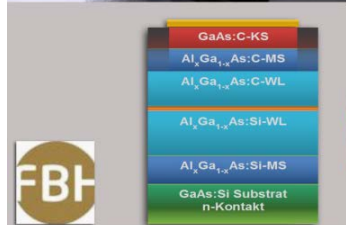
Bild 2 c) Design: Laserstruktur mit unsymmetrischem Wellenleiter
