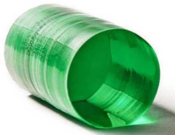
Bild 1: Cr-dotierter LiCAF Laserkristall (Quelle: IKZ)
