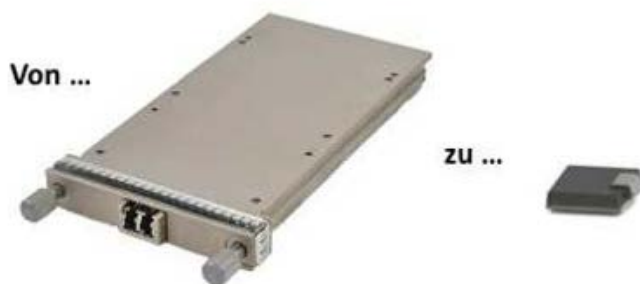
Bild 2: Vision des Speed-Projekts / Hochbitratige optische Transceiver mit elektro-optischen ICs auf Silizium. (Quelle: ADVA-AG)
