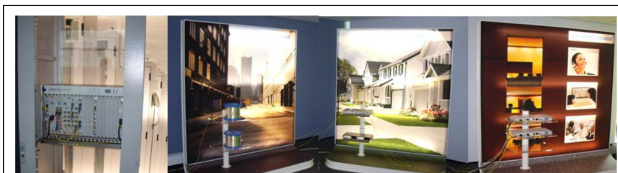
Architektur- und Gerätekonzepte von der Optical Line Termination (OLT) in der Vermittlungsstelle (links) über die Verzweigungs- und Verteileinrichtungen in den passiven Remote Nodes am Straßenrand (Mitte) bis hin zur Optical Networking Unit (ONU) beim Teilnehmer (rechts) werden im Projekt entwickelt und in einem Feldversuch demonstriert.
