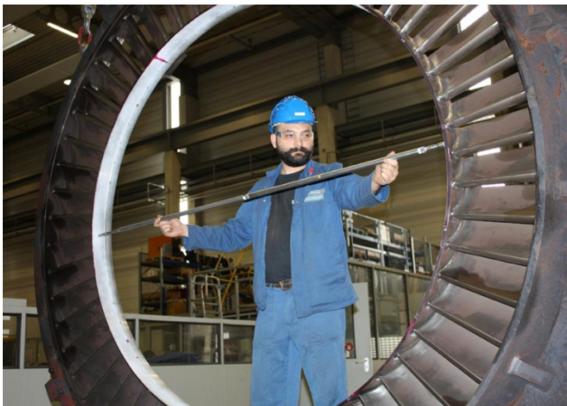
Bild 2: Große Durchmesser werden heute i.d.R. aufwendig manuell geprüft. Abhilfe soll eine faseroptische Mehrstellenmesstechnik schaffen. (Quelle: Siemens AG)
