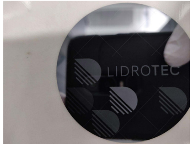
Sauber strukturierter Wafer durch Laserbearbeitung in Flüssigkeiten.
