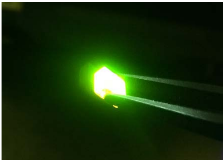
Bild 2: Lichtemission eines \text{CH}_3\text{NH}_3\text{PbBr}_3 -Einkristalls. (Quelle: Bergische Universität Wuppertal)
