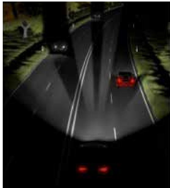
Bild 2: Schema der Funktionalität eines adaptiven Frontscheinwerfers. (Quelle: Hella).
