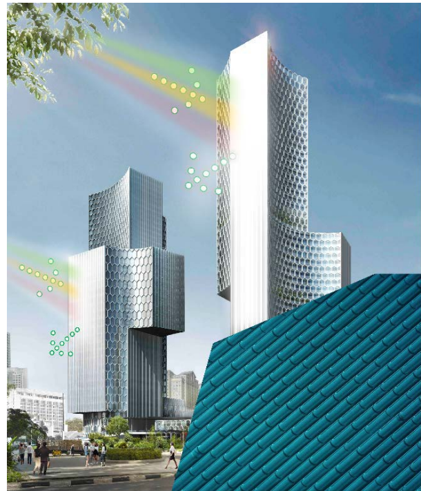
Bild 2: Mikrospiegelarrays zur Lichtlenkung an Fassaden (Quelle: B. Al-Qargholi)
