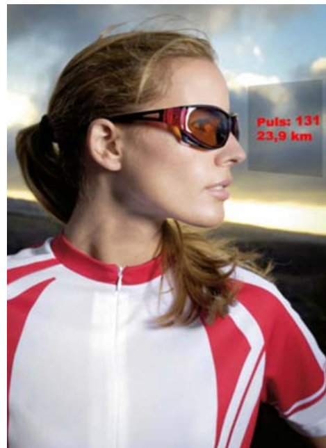
Sportbrille mit optischer Dateneinspiegelung (Quelle: Carl Zeiss)
