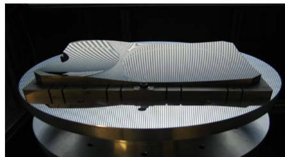
Freiformspiegelpaar aus Direktherstellung mittels Ultrapräzisionsbearbeitung (Quelle: Carl Zeiss Jena GmbH)
