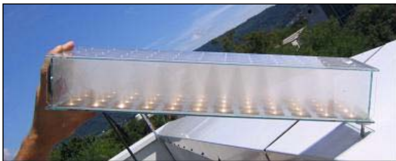
Konzentrator Modul (FLATCON der Fa. Soitec Solar). Der eingeblassene Rauch verdeutlicht den Strahlengang des 500 fach konzentrierten Sonnenlichtes. (Quelle: Fraunhofer ISE)
