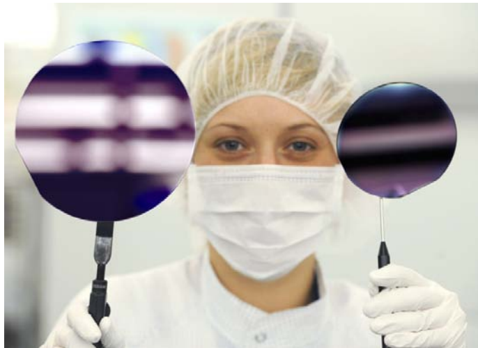
Bild 2: Wafer aus der LED-Fertigung mit 150 bzw. 100 mm Durchmesser (Quelle: Osram OS)
