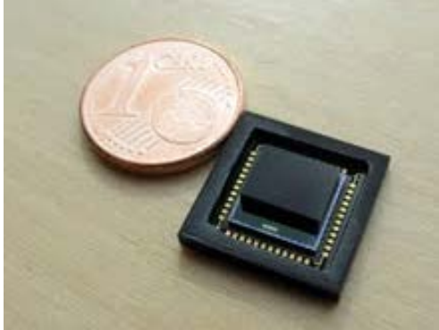
Bild 2: Kopf einer 1,4mm flachen Multiapertur-Kamera für Anwendungen in der Videotelefonie. Quelle: Fraunhofer IOF, Jena
