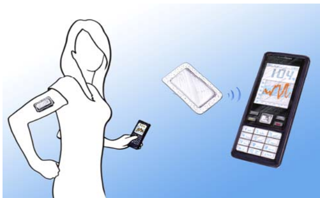
Bild: GlucoSens – Integrierte, durch Organische Elektronik verbesserte Sensoren sowie Mess- und Übertragungseinheit als flexibles Hautpflaster zur kontinuierlichen Kontrolle des Blutzuckerspiegels beim Diabetiker
