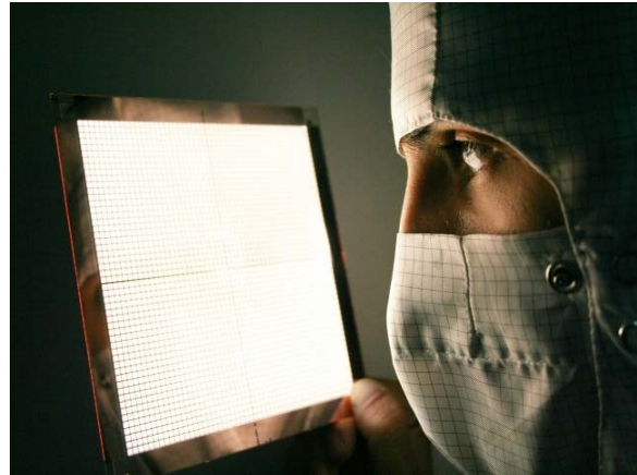
Weißer OLED für die Beleuchtung (Quelle: Osram OS)
