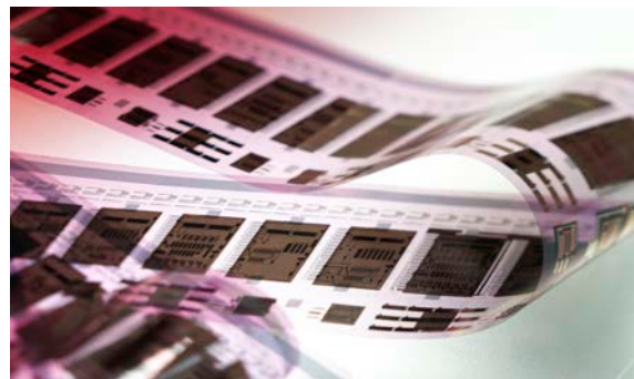
Gedruckte organische Schaltungen von der Rolle für RFID Anwendungen (Quelle: PolyIC GmbH)
