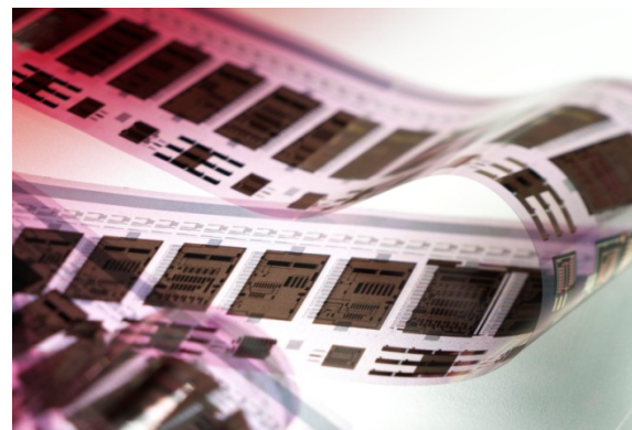
Bild 1: Gedruckte organische Schaltungen von der Rolle für RFID Anwendungen (Quelle: PolyIC GmbH)
