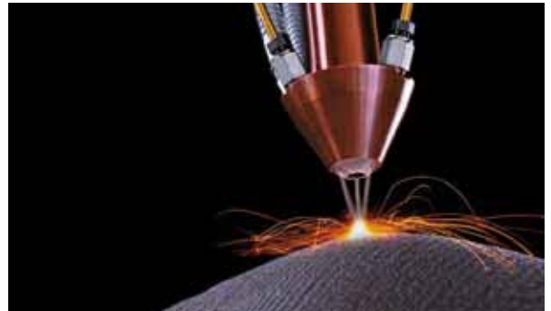
Laserbearbeitung mit Pulverzuführung, Quelle: TRUMPF GmbH + Co. KG
