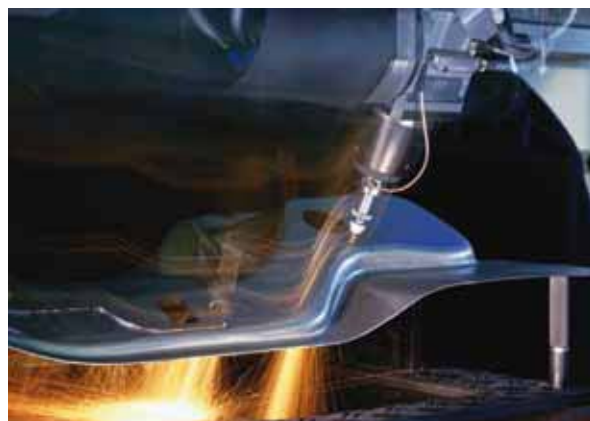
Laserschneiden an einem tiefgezogenen Blech, Quelle: TRUMPF GmbH + Co. KG
